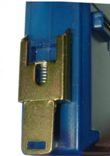
Figure 11. DIN Clip on a Serial Server Module
