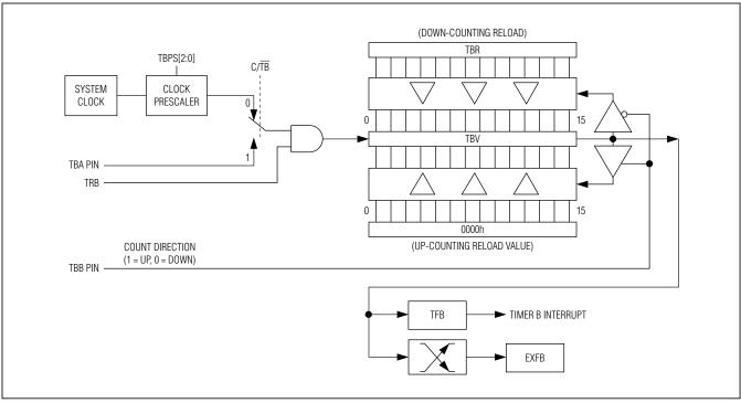
Figure 7-3. Timer B Up/Down Autoreload Mode
