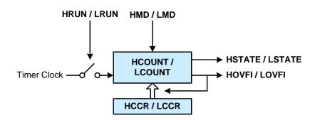
Figure 36.7. Auto-Reload Mode Block Diagram
