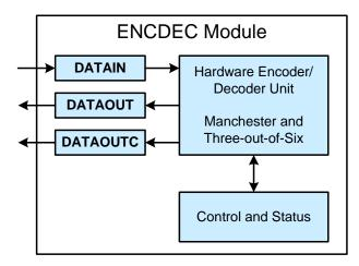
Figure 21.1. ENCDEC0 Block Diagram
